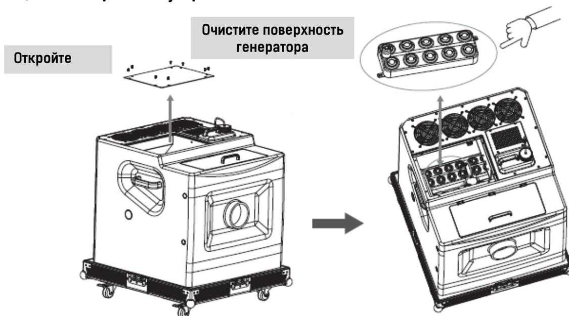
4. При длительном использовании в баке для воды может образовываться накипь, либо в него может попадать мусор. Регулярно проводите очистку.
